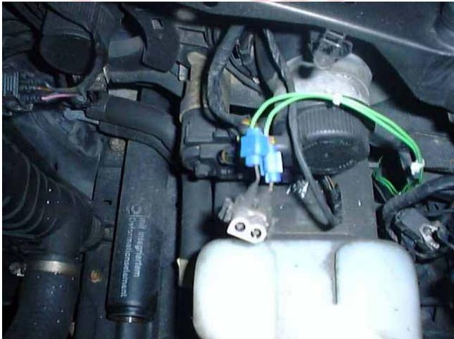
Auf der Beifahrerseite gibt es jetzt kaum Masse - Anschlussmöglichkeiten, außer an dem Masseanschluss der Motorhaube, dazu musst du aber das Kabel verlängern! Oder den Wassertank demontieren, denn darunter befindet sich eine Schraube zum Anschluss des Massekabels (wie ich im nachhinein erfahren habe). Deine Entscheidung. Oder du nimmst alternativ BEIDE Kabel die an das Standlicht führen.
