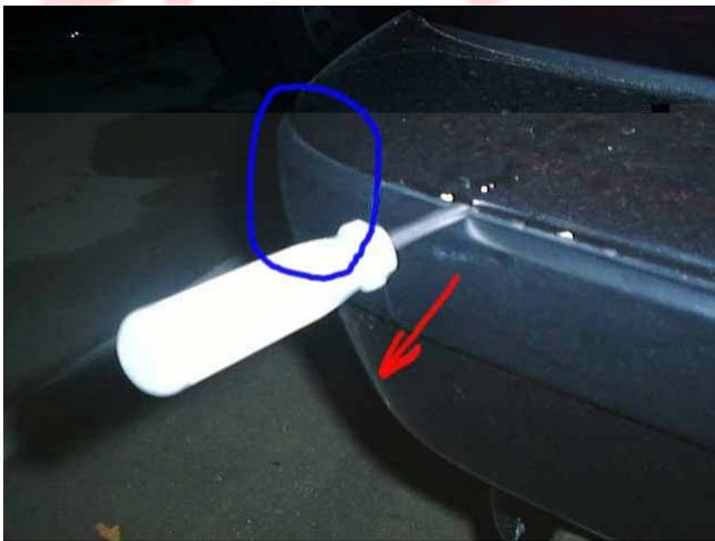
Als erstes machst Du hinten die Stossleiste weg. Mit dem Schraubenzieher über der Stossleiste VORSICHTIG eintauchen und die Leiste herausdrücken oder seitlich ansetzen (ist nur geclipst).
