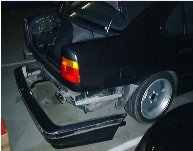
Sollte es immer noch nicht gehen, mach die Schrauben runter, schiebe den Spritzschutz der Stossstange an dieser nach vorne vorbei und nimm die Stossstange ab (So hab ich es gemacht).
