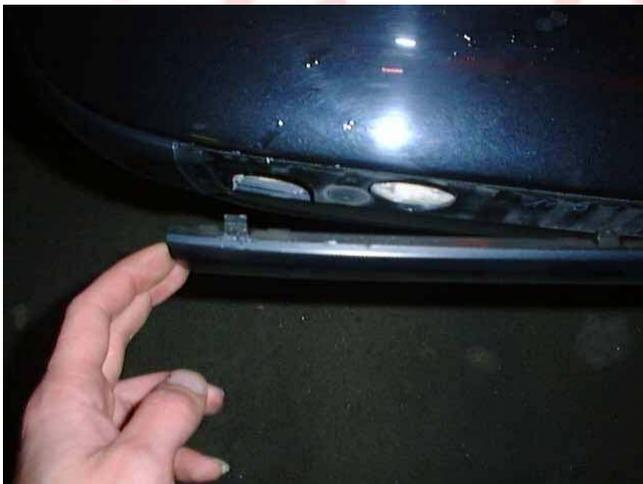
Danach die Leiste mit Gefühl, Clip für Clip abziehen. Jetzt sind unter anderem, auf jeder Seite 2 Muttern sichtbar, die deine Stossstange halten. Jetzt liegen beide enden der hinteren Leisten frei zugänglich und du kannst mit dem Schraubenzieher darunter fahren und diese ebenfalls aushebeln (Achtung: Nur bis zum Radius! Danach kommen Haken die du sonst abbrichst).
